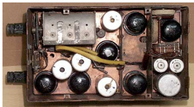
Bild 4: Blick in das Innere des IA-42.
