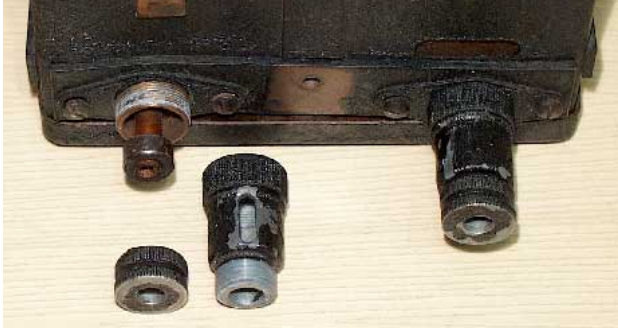
Bild 5: Anschlusstücke am IA-42, links auseinander geschraubt.
