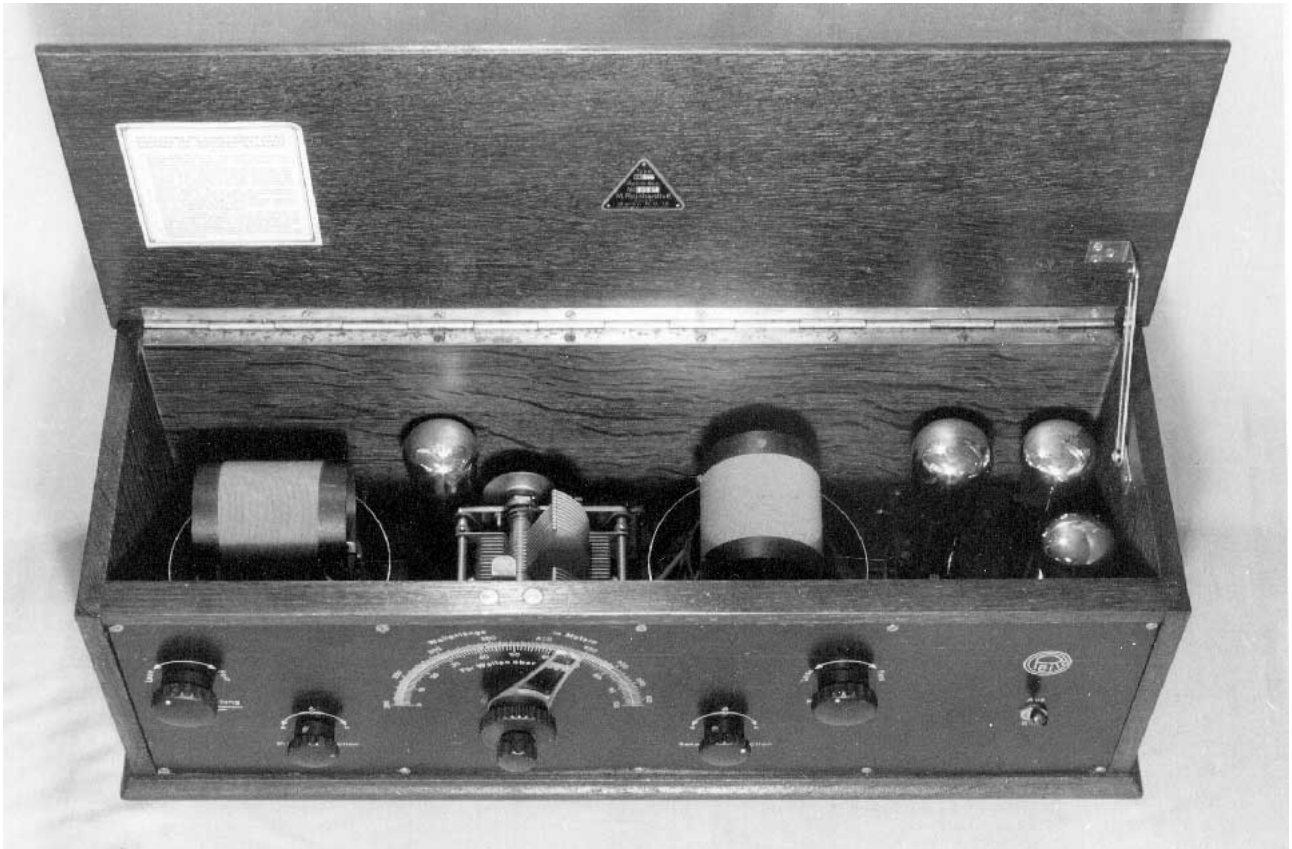
Bild 2: Bei geöffnetem Deckel erkennt man die um 90 Grad zueinander versetzten Spulen.
