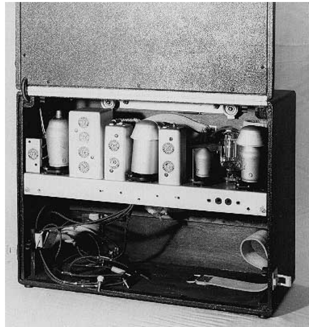
Bild 7: Für über 30 Jahre typischer Aufbau eines Koffergerätes: oben Empfängerchassis, unten Raum für Batterien, in der Mitte der Lautsprecher (auf der Abbildung: Körting "Tourist" 1937/38, die Rahmenantenne befindet sich in der hochgeklappten Rückwand).
