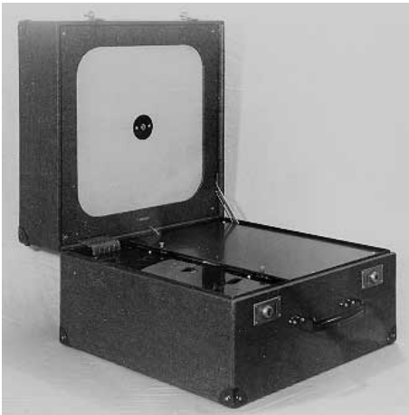
Bild 4: Kofferempfänger mit eingebautem Lautsprecher 1930/31 (Typ Nora S 4 K). Im unteren Teil links der Empfänger, rechts der Raum für die Batterien, im Deckel Lautsprecher und Rahmenantenne.
