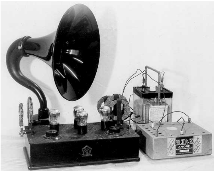
Bild 2: Typische Rundfunk-Empfangseinrichtung um 1925/26 mit Empfänger, Trichterlautsprecher, Heizakku und Anodenbatterie.
