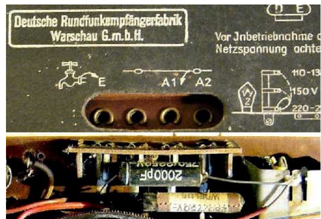
Bild 12: Antennenbuchsen-Beschaltung bei Derufa-DKE mit Siebdrossel und A1-A2.
