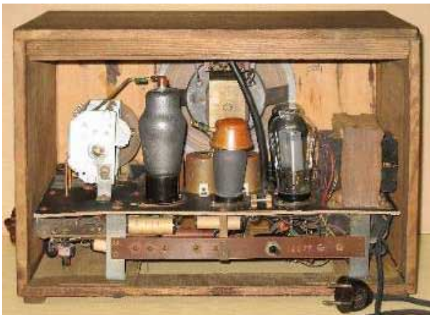
Bild 16: Wie sich die Bilder gleichen! Pappchassis noch 1950 im Graetz 80 W/M wie schon Jahre zuvor im JDEAL W 1348 A (Bild 17).
