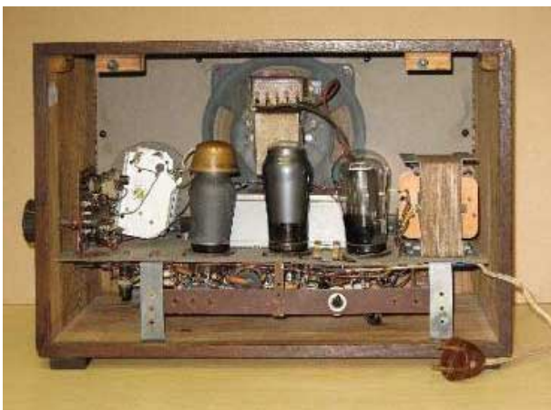
Bild 17: Blick ins Innere des JDEAL W 1348 A.
