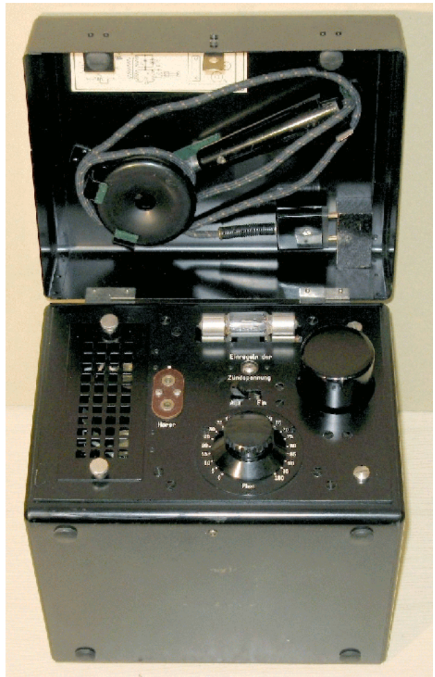
Bild 4: Neue Version ab 1936. Der Messbereich erstreckt sich in 5-er Stufen von 0 bis 100 Phon.
