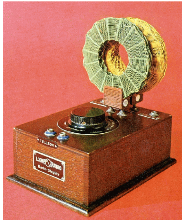
Bild 1: Der in der "Loewe-Story" abgebildete angebliche "Loewe-Detektorempfänger".
