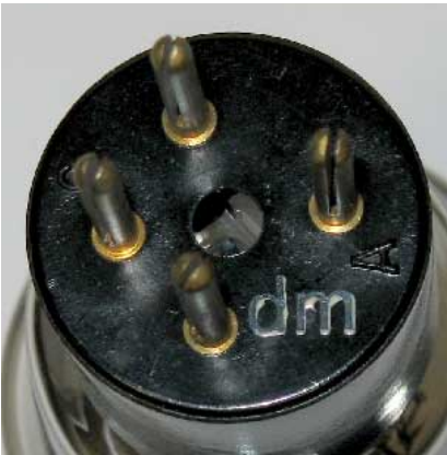
Bild 10: Kennzeichnung mit Kleinbuchstaben; dm = 01.31
