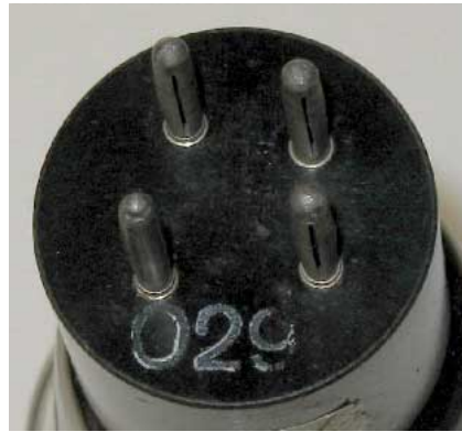
Bild 11: Von Valvo bezogene Telefunken-Röhren haben einen deutlich größeren Nummernstempel; 029 = Februar 1929
