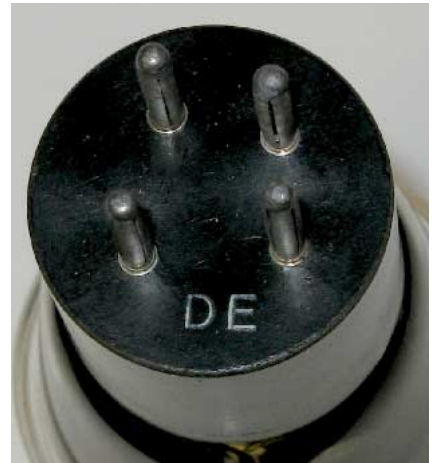
Bild 12: Telefunken-Röhre von Valvo mit Großbuchstaben; DE = 07.30
