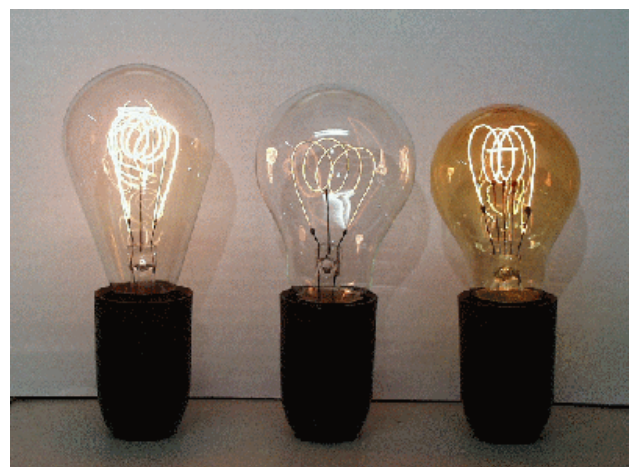
Bild 4: Kohlefadenlampen im Vergleich, alle parallel an 180 Volt. Links: Originallampe 220V-16HK, Mitte: NoName 230V-60W, rechts Paulmann (Radium) 230V-60W.
