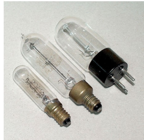
Bild 2: Ansicht vom Lorenz Original EW.100 (Mitte), Äquivalent-EW Philips 1904 (rechts) und Ersatzlampe (links).
